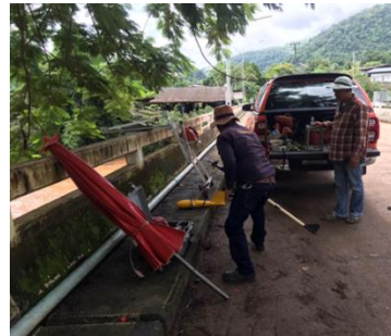
รูปที่ 5.9-4 ทำการสำรวจปริมาณน้ำและการสำรวจตะกอนแขวนลอยสถานี P.92 น้ำแม่แตง บ้านเมืองก๊ิด อำเภอแม่แตง จังหวัดเชียงใหม่
