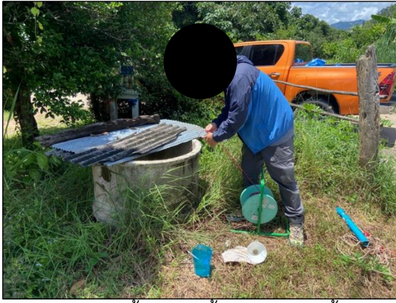
วัดระดับน้ำจากบ่อน้ำบาดาลระดับต้น (บ่อชุด พื้นที่อำเภอแม่แตง)
